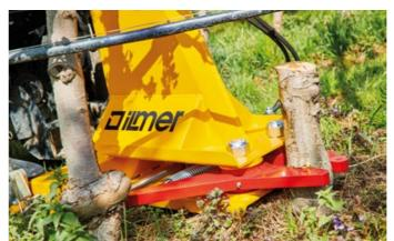
Die kraftvolle Greifzange mit Hebel-Übersetzung sorgt für festen Biss. Dadurch können Baumstämme oder Rebstöcke schnell und einfach entwurzelt werden.
